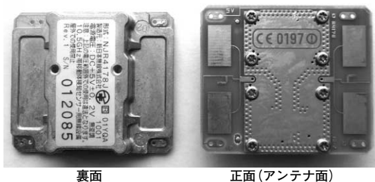
〈写真3〉入手容易な市販のマイクロ波ドップラー・センサ NJR4178J (送信アンテナと受信アンテナを内蔵している)
