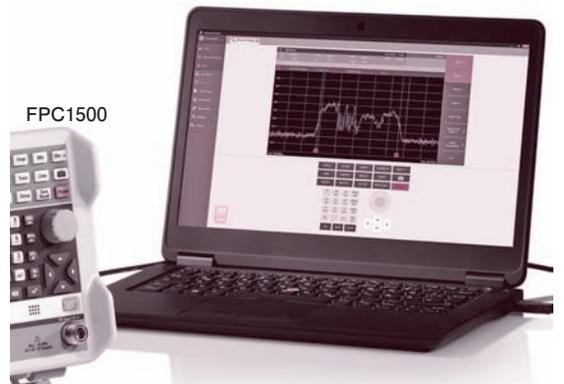
〈写真2〉 InstrumentViewによるリモート制御中のパソコン画面
